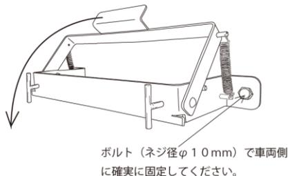
ボルト（ネジ径φ10mm）で車両側に確実に固定してください。
