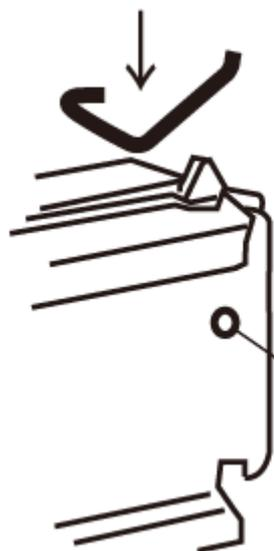
③新しいトリガーをスライドビームにセットし、ピンで固定して下さい。
